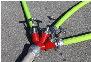
Abbildung 4 - Anschluss von mehreren Rohren am Verteiler
