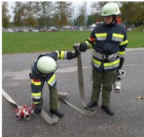
Abbildung 1 - Ankuppeln des C-Druckschlauches am Verteiler
