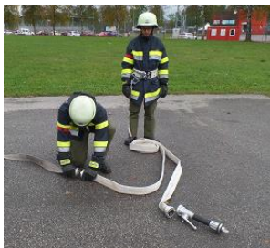
Abbildung 2 - Kuppeln der C-Druckschläuche und des Strahlrohres
