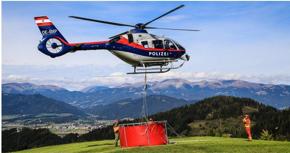
Abbildung 3: Löschwasserbehälter 6.000 Liter (LFV Tirol)
