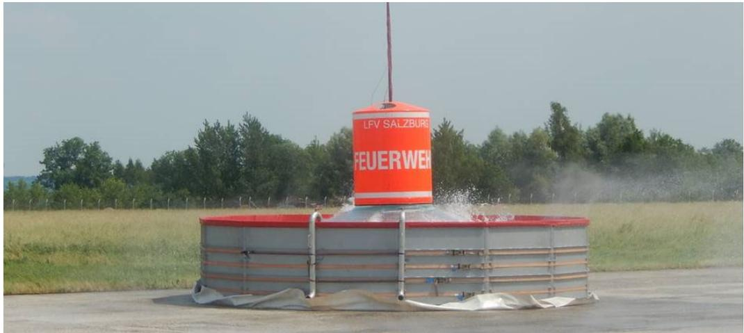
Abbildung 7: Löschwasserbehälter 50.000 Liter (LFV Oberösterreich)
