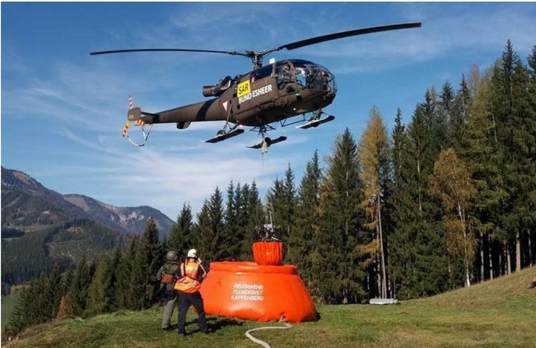
Abbildung 5: Löschwasserbehälter 15.000 Liter (LFV Tirol)
