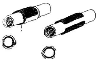
Sehr wirksame Hilfsmittel zum Abdichten von Leckagen an Rohrleitungssystemen können Wickel aus Gummi oder auf einer Seite **aufgeschnittene Schläuche** sein, die mit Schneckengewindeschellen etc. über der Leckstelle befestigt werden.
