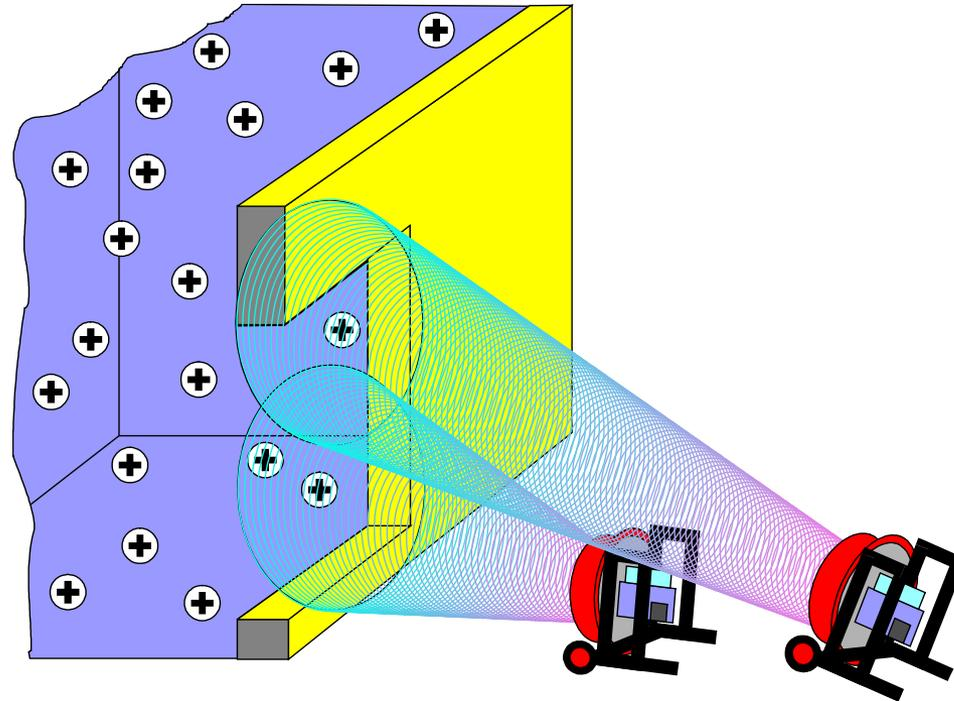
Um bei hohen Öffnungen eine Abdeckung der Zuluftöffnung zu erreichen, erfolgt der Lüftereinsatz in "Reihe oder Hintereinander"
