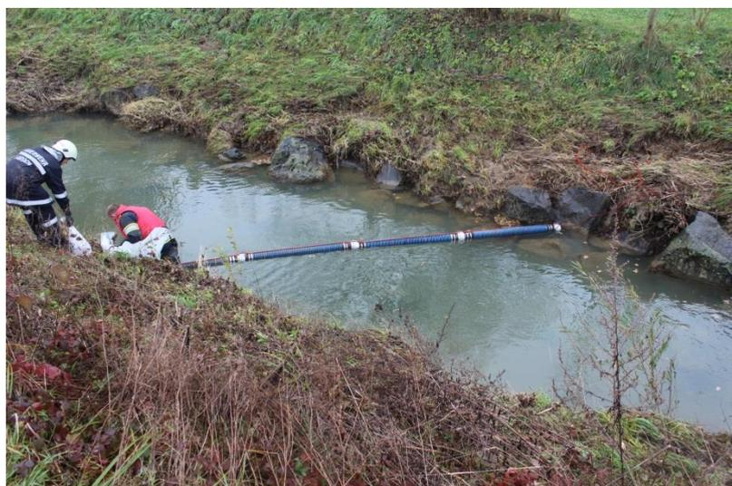
4 A-Sauger mit Saugschlauchleine zur Entlastung
