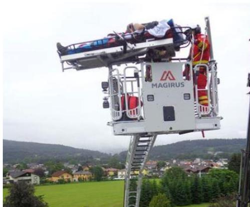
Bei den neuen Rettungskörben von Teleskopmastbühnen ist auch ein fachgerechter Transport mit einem Rollstuhl möglich.
