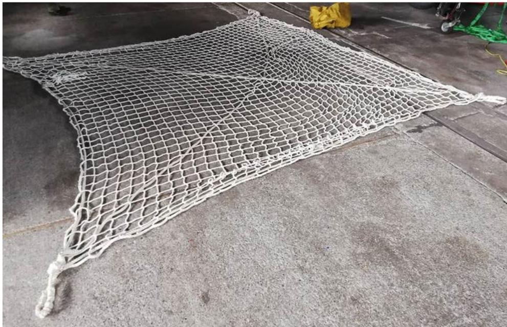
Abbildung 10: Lastentransportnetz (LFV Oberösterreich)
