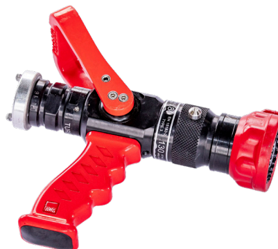
Abbildung 42: D-Hohlstrahlrohr - 25 bis 130 l/min Wurfweiten bis ca. 20 Meter.
