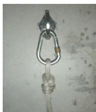
Um ein unbeabsichtigtes Aufschrauben des Schraubkarabiners durch Vibrationen zu vermeiden, muss dieser mit der Öffnung nach unten eingebaut werden.
