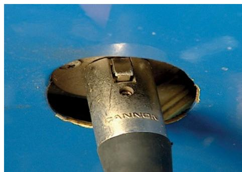
Abbildung 2 & 3: Lasthaken und Stromanschluss bei AS 350 (LFV Tirol)
