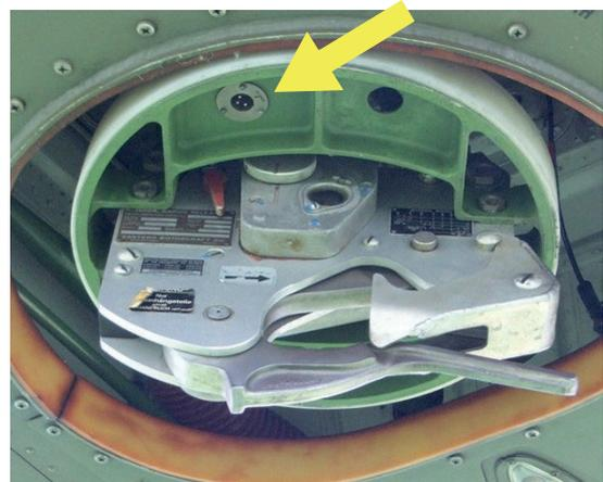
Abbildung 8 & 9: Lasthaken (links) und Stromanschluss (rechts) AB 212 (LFV Tirol)
