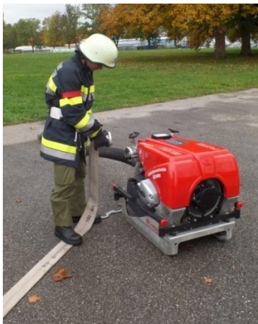
Abbildung 1 - rechts: beim Ankuppeln an der TS
