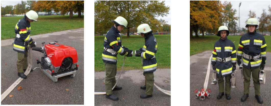
Abbildung 5 - WTR beim Ankuppeln an der TS; ATR beim Kuppeln der Zubringleitung;
