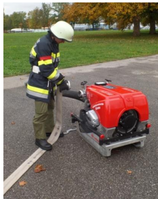
Abbildung 4 - B-Schlauch an TS ankuppeln
