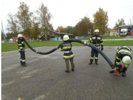
Abbildung 3 - Leinen anlegen durch WTR und STR, Ankuppeln der Saugleitung an der TS
