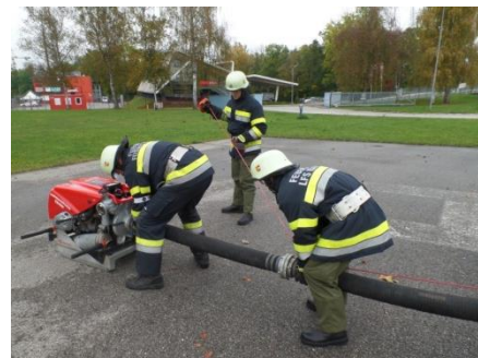
Abbildung 3 - Leinen anlegen durch WTR und STR, Ankuppeln der Saugleitung an der TS
