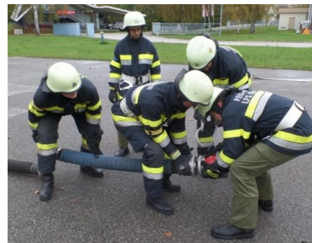
Abbildung 2 - : Absetzen der TS, Kuppeln des Saugkopfes
