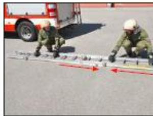
Sind die Leiterteile zusammengefügt, begeben sich zwei Personen an den Leiterfuß und zwei an den Leiterkopf. Der am Leiterfuß befindliche Trupp verhindert während des Aufrichtens der Leiter das Wegrutschen.
