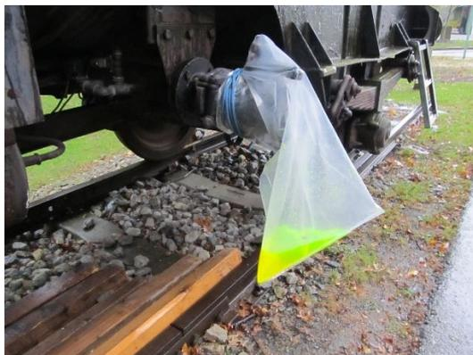
Geht das Nachziehen des Ventilrades oder der Schutzkappe nicht wird ein **Kunststoffsack** über die undichte Armatur gezogen und fest verschnürt.
