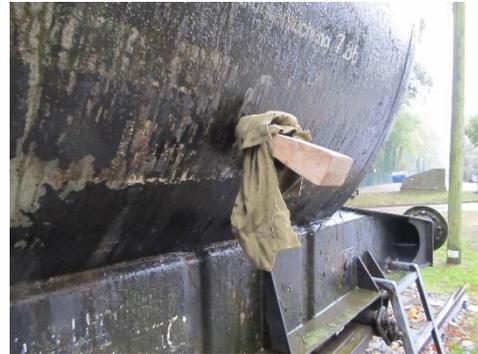
Kleine Leckagen, aus denen **Druckgase in der Flüssigphase austreten**, lassen sich vorübergehend durch einen Eiswickel abdichten. Dazu wird ein trockener Lappen um das Leck gewickelt und dann mit Wasser besprüht. Das in der Flüssigphase austretende Druckgas geht unter Abkühlung auf bis  $-70^{\circ}\text{C}$  in die Gasphase über und lässt den mit Wasser besprühten Lappen zum abdichtenden „**Eiswickel**“ erstarren.
