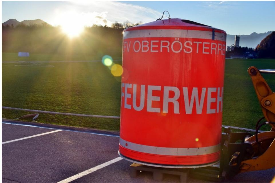
Abbildung 2: Löschwassertransportbehälter Semat 3.000 Liter (LFV Tirol)
