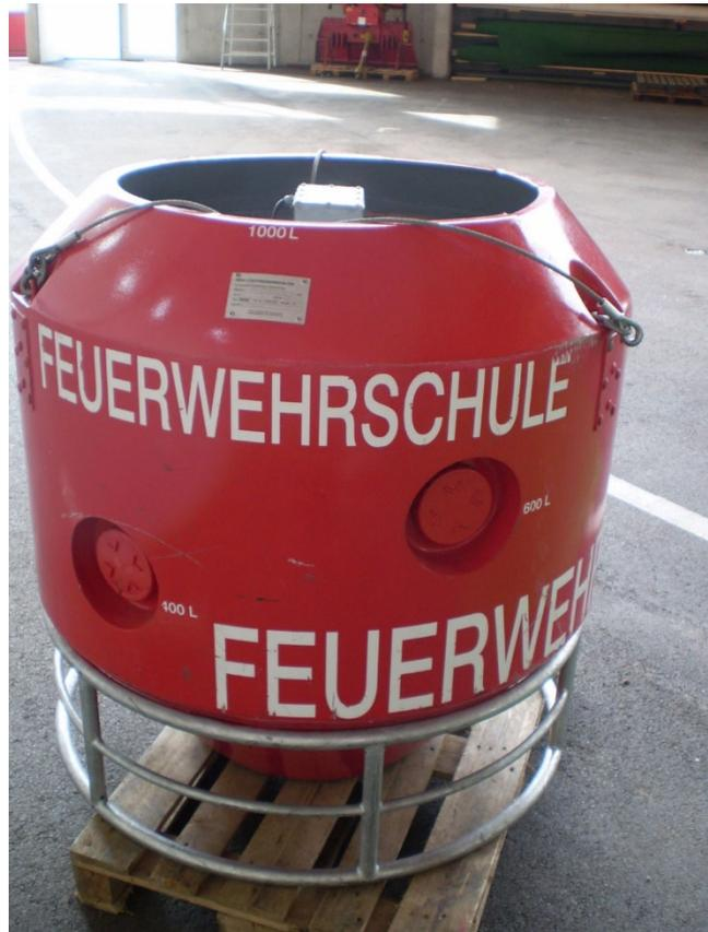
Abbildung 3: Löschwassertransportbehälter Renzler 1.000 Liter (LFV Tirol)
