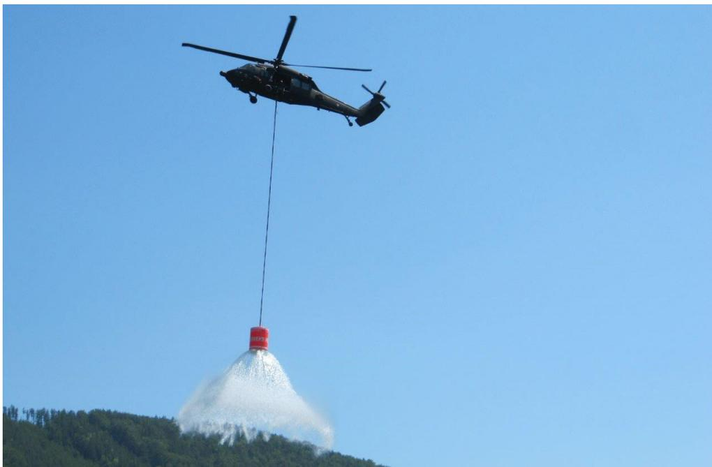
Abbildung 1: Löschwassertransportbehälter Semat 3.000 Liter (LFV Tirol)
