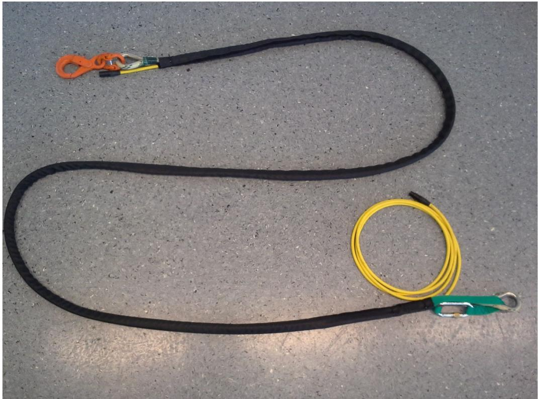
Abbildung 10: Lastentau mit Elektrokabel (LFV Tirol)
